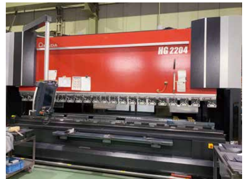
220TON ベンダー 曲げ能力最大4m
